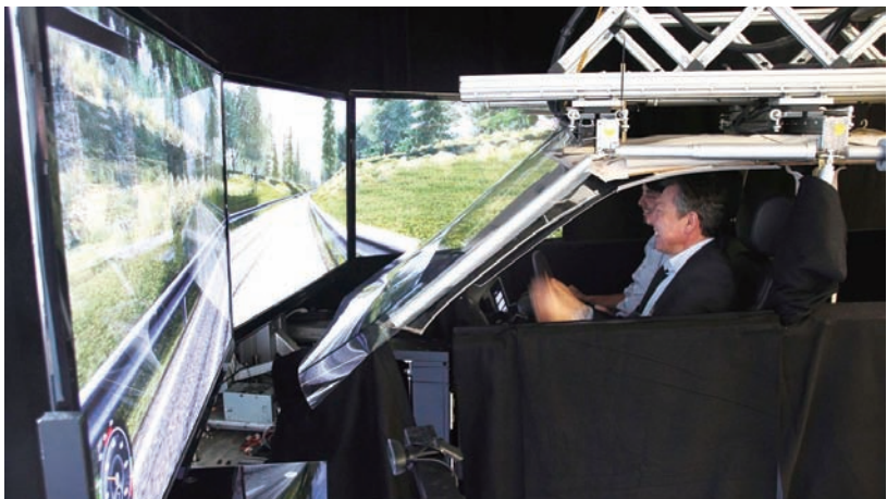
图5 基于物理台架的汽车人机工程虚拟仿真系统
