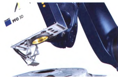
图10 激光飞行焊接技术
