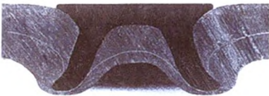
图1 SPR连接工艺
