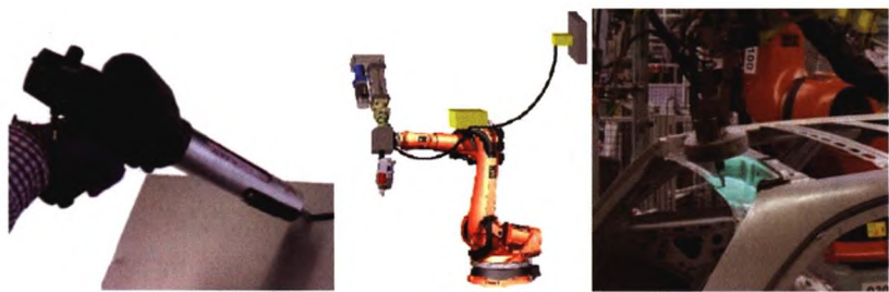
图1 人工涂胶设备、机器涂胶设备和摄像机辅助检查设备
