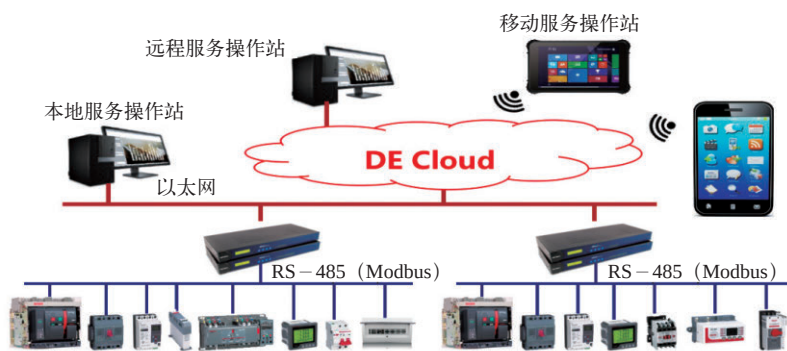
图1 典型的基于云服务的智能配电系统
