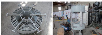
图4 新汇流方式验证试验
