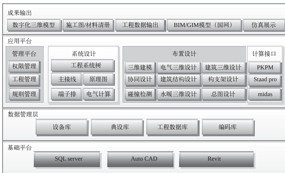
图1 STD-R数字化变电三维设计平台的架构
