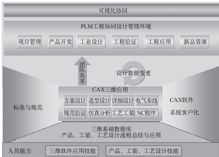
图2 数字化开关样机总体方案框图
