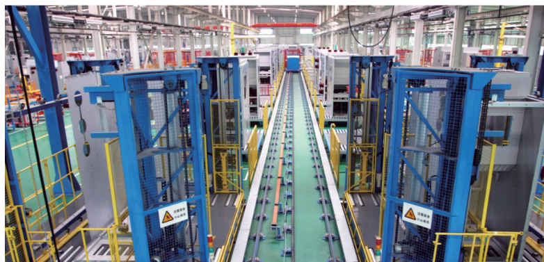
◎ 35 kV开关柜智能总装线
