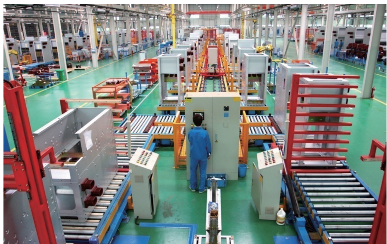
◎ 10 kV开关柜智能总装线
