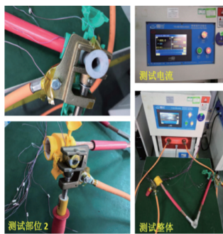
图 产品过电流能力及温升测试
