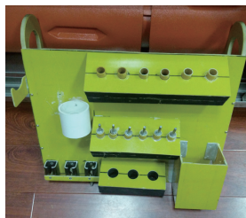
图4 加工后的工具挂板装置实物图
