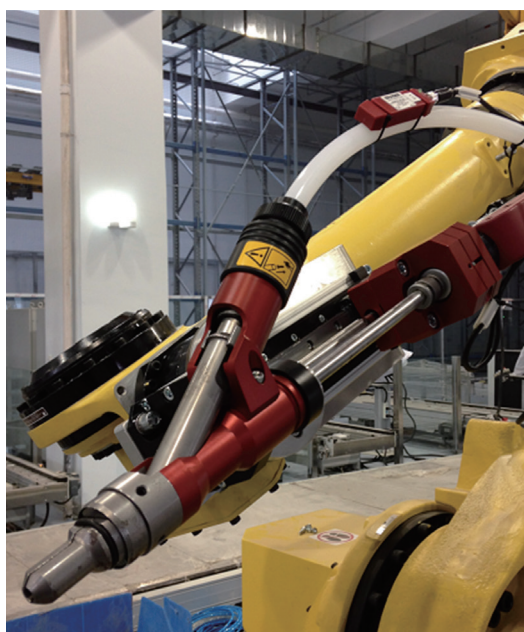
图3 集成了送钉与拧紧的自动化装配系统
