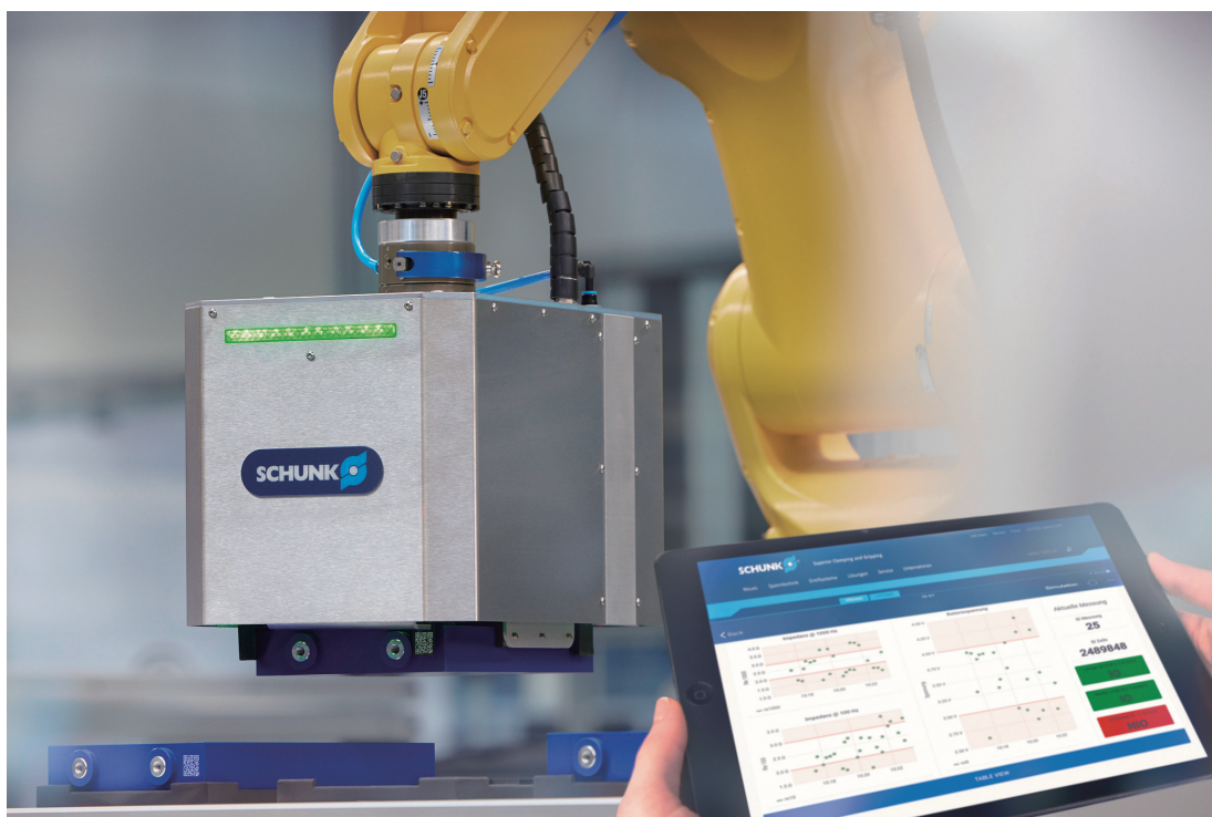
◎ 智能的雄克电池组机械手能够在搬运过程中测定所有与质量相关的锂离子电池的几何和电参数
