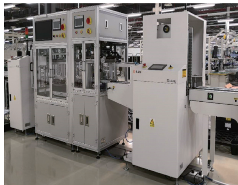
图4 自主设计的PCBA自动测试线
