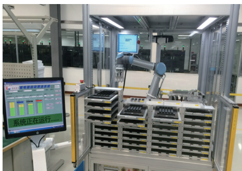
图5 自主设计的机器人智能化进料检测系统
