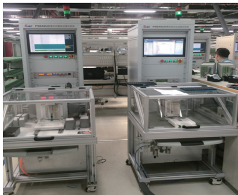
图3 自主设计的IED自动测试系统
