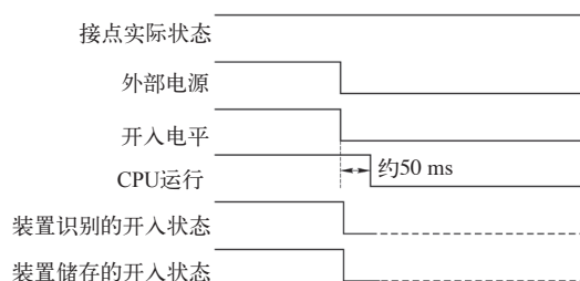
图2 断电后错误的状态被存储
