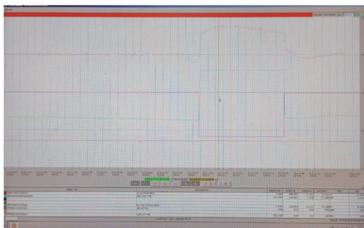
图5 补汽阀参与额定1 050 MW负荷一次调频试验成功
