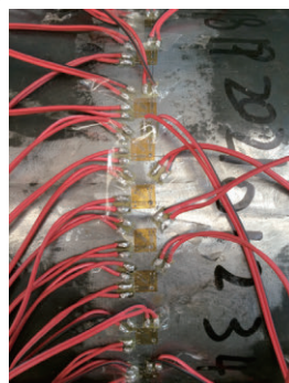
图5 钻孔后的应变花
