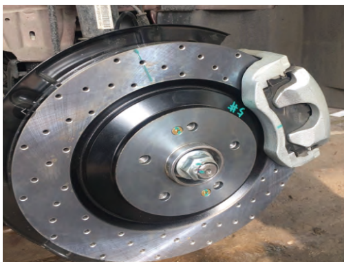
图 8 制动盘开渐开线孔方案
