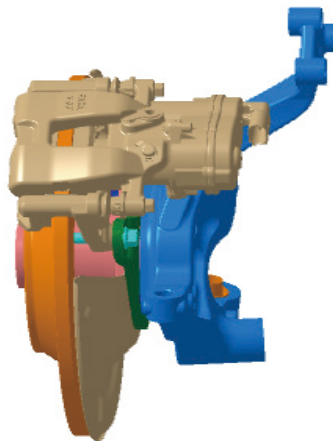
图 1 集成 EPB 卡钳的后浮动卡钳盘式制动器
