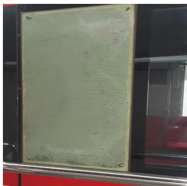
图 3 面板大面积胶粘附破坏
