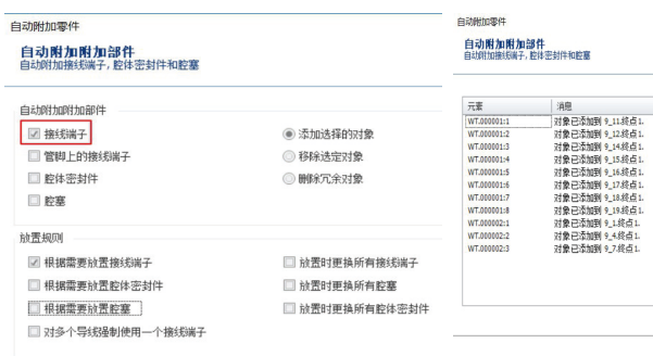
图 9 自动附加接线端子
