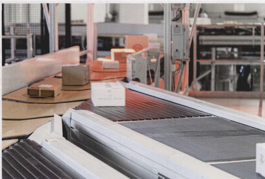
图 1 新建分拣中心的核心设备是 BG Sorter 公司研发生产的包裹分拣机
