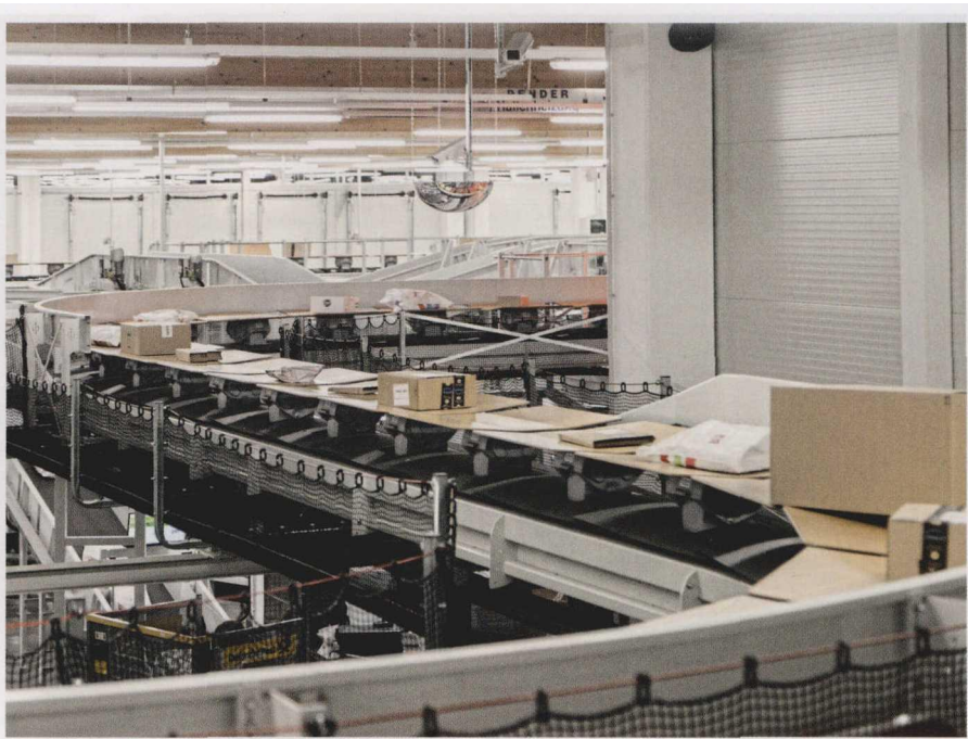
图 3 分拣设备能够以很高的输送量安全、可靠的分拣不同的包裹
