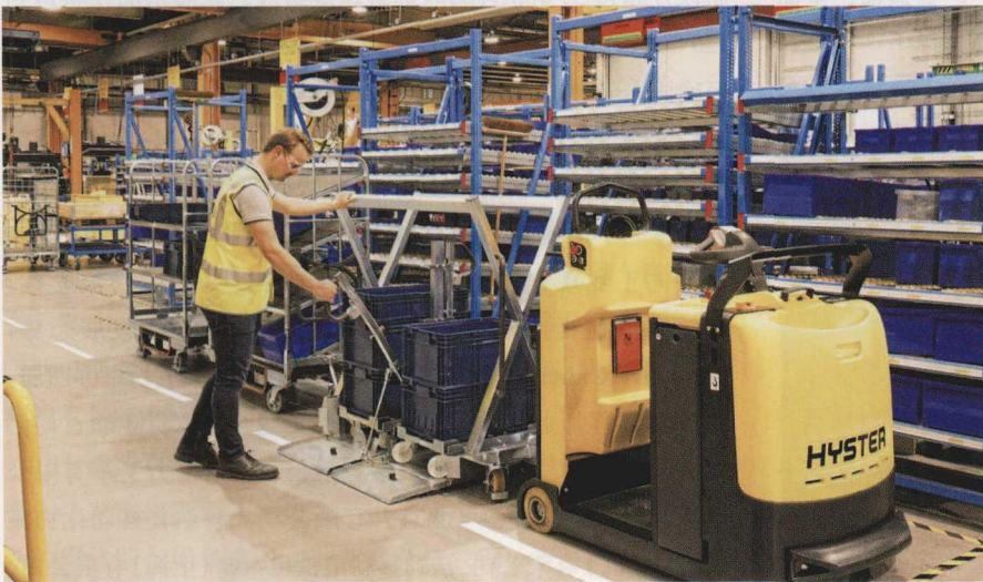
图 2 Hyster 公司的自动导航运输车可以组成不同的零部件运输车队
