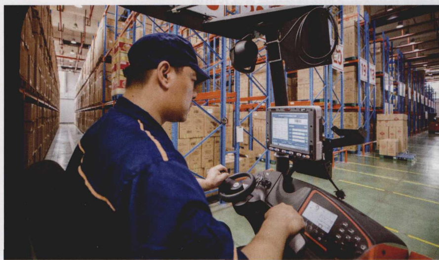
林德自动导航叉车可以自动定位在通道内水平和垂直方向的位置，同时提供声音和视觉上的辅助，并根据目标地址自动优化运行速度
