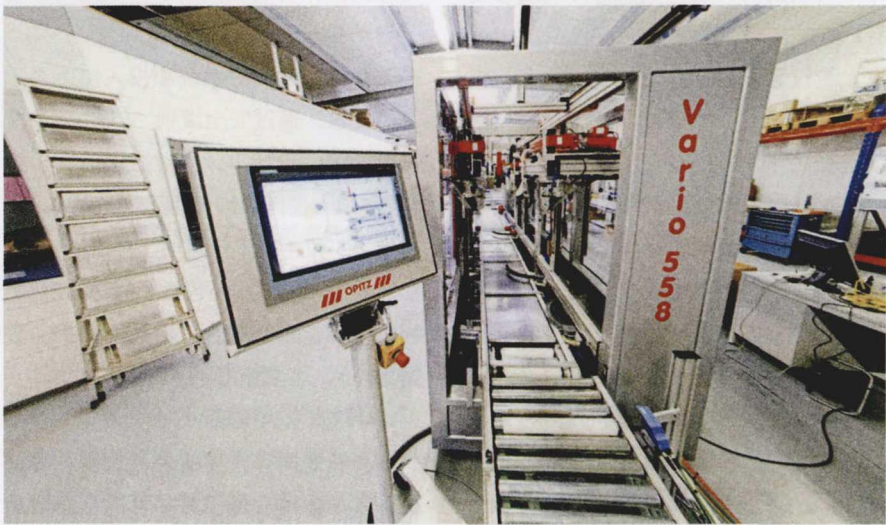
图 2 减容器 Vario 558 的内部预览：机器将包装纸箱的体积降至最小
