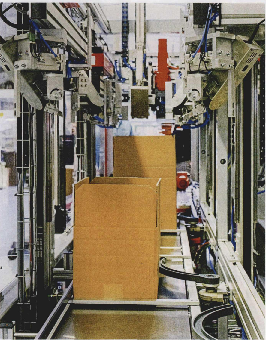
图 3 具有不同高度和相应压纹凹槽的个性化基础形状，折叠纸箱经过如此优化后，以最小体积实现了最大程度的合理化包装和运输安全性
