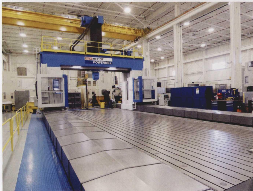
图 2 Baker 公司积极主动投资新技术，即使并不确定新技术能否应用。图中所示包括公司的新款五轴龙门机床、工作包线 52 × 20 × 10 ft，工作台承载能力为 260 万 lb。该公司购买这款机器主要是为了增加其能力，以适应 OEM 和一级客户的最大加工项目
