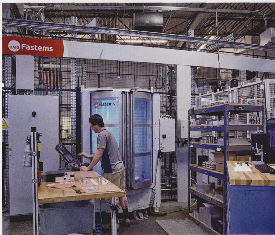
图 3 Hirsh 公司的 36 托盘 FMS 系统将系统服务的 2 台五轴机器的主轴正常运行时间最大化，这家车间正在计划为该 FMS 系统增添第 2 台机器
