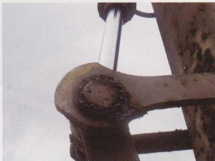
过量的润滑脂已经冲破密封圈，持续吸附颗粒物，进而磨损接头
