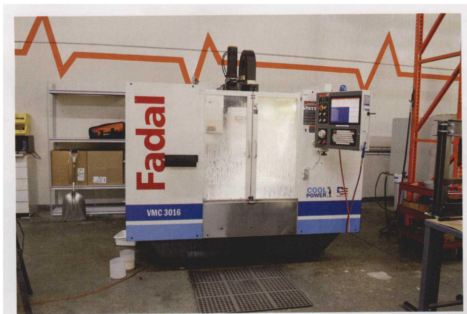
图 2 该公司购买了改装后的 Fadal 3016HT VMC，用于模具生产。机器外形似新，但是采用的还是原来的控件，估计已经用了 25 年了。也就是说，虽然机器尚能正常工作，但是 CNC 的加工能力无法满足史密斯提出的进给速度
