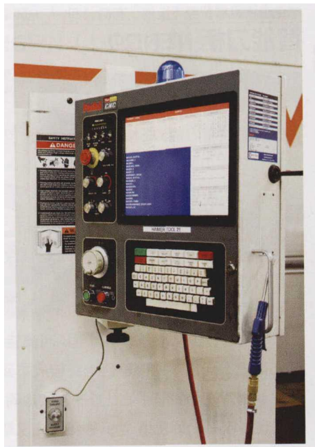
图 3 Smith 先生用 Calmotion 公司的 527F 控件代替了原控件，527F 控件效仿最初的 Fadal 控制，将速度提高了 30 倍，并进一步扩大了内存
