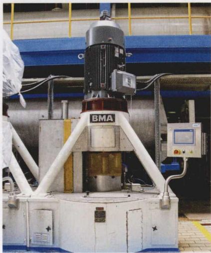
图 1 在 BMA B1750 型离心机上使用了再生式变频器 ACS880-17
