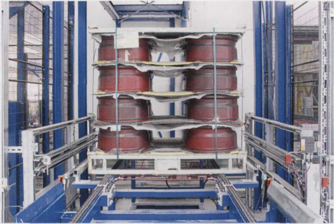
图 3 Otto-Fuchs 集团公司新建的 HRL 高架立体库可用于车轮和原材料供应时的中间缓冲
