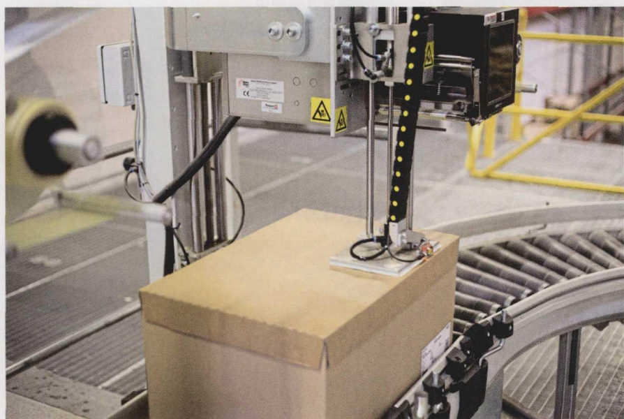
图 1 贴标头旋转臂伸出来，直到它探测到包装物的上表面为止，全过程无接触的将标签吹贴到位
