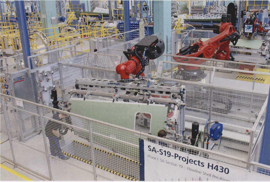
图 2 来自第一个自动区域的组件被松开并送到下一个手动工位，然后在这里进行半个壳体的组装，借助 RFID 芯片可以无缝追踪制造过程中的部件
