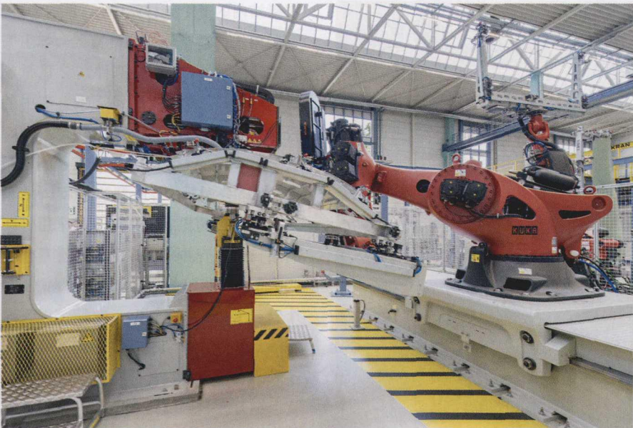
图 4 如纵梁、夹子等单个部件的对准和壳体构件的拼接是手动完成的，钻孔、扩孔和铆接则高度自动化，机器人处理部件并将组件送入铆接机
