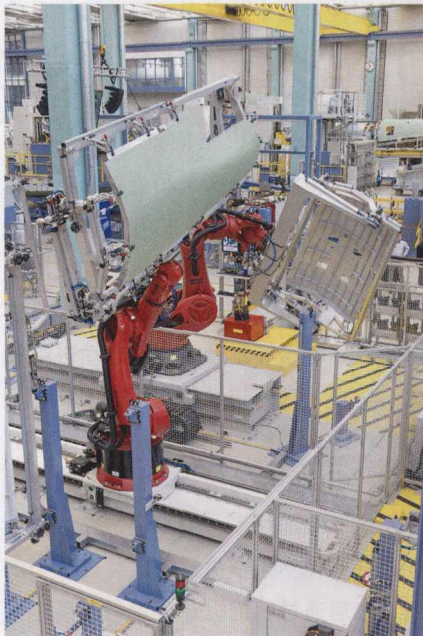
图 3 手动放入构件支架中的组件被送到自动区域，线性轴上的操作机器人接过构件支架，并根据需要将其分配到两个铆接站内其中一个可以使用的转移站中
