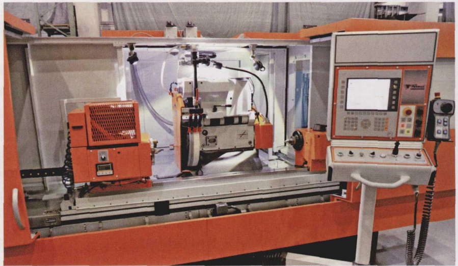
图 2 拥有双旋转磨头、液体动压轴承和可变速控制的 BUB E 50/1000 CNC 磨床的工作空间
