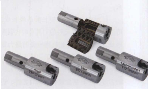
图 5 刀具轻型化是 3D 打印技术在刀具制造上所能提供的优势之一
