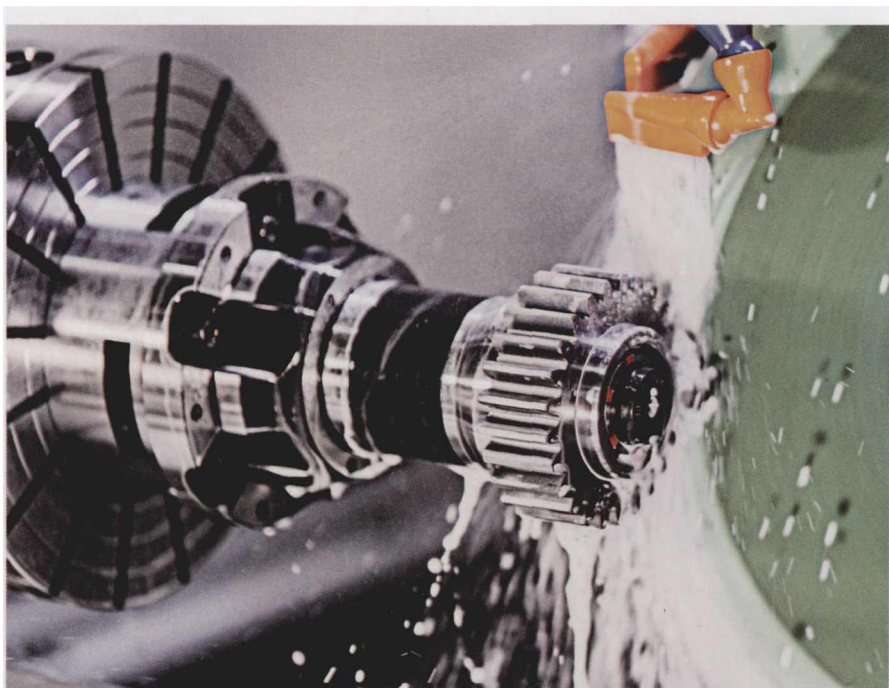
图 1 Hainbuch 公司 Mando G211 标准型装夹心轴适用于对齿轮部件的装夹
