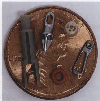
图 5 2017 年推出的 M5 生产桌面微成形平台制造的各种材料（热塑性塑料、有机硅、金属、生物可吸收材料等）的模制品。该平台可用于生产尺寸在 0.003 in 3 及以下的部件
