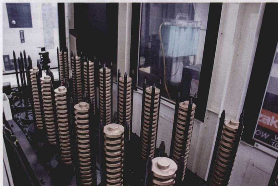
图 3 该车间采用龙门式装载机，实现 Integrex 机器自动化。特雷梅因先生说道，每台机器上的自动工件搬运和多切割操作实现了连续生产和无 WIP 积压
