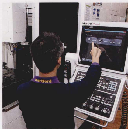
图3 智慧型控制器 Hartrol Plus 安装了 Set and Inspect，操作更简易了
