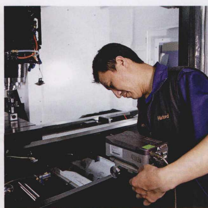
图4 协鸿配备 XL-80 激光干涉仪用于数控机床校准
