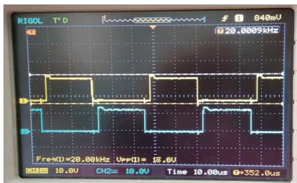
图6 添加死区时间补偿方法后同一桥臂上下IGBT的驱动波形
