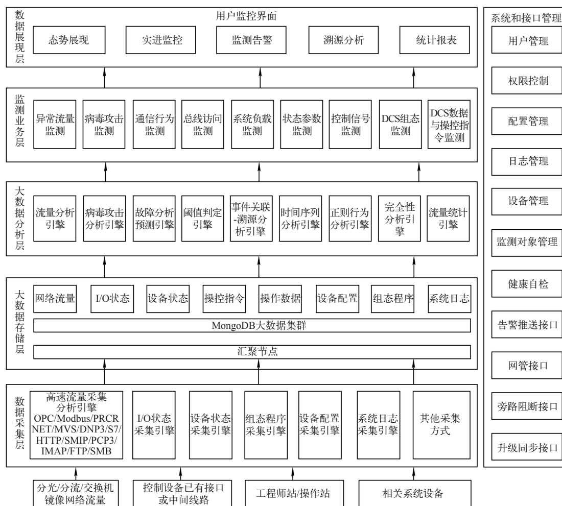
图5 电力工控系统威胁监测体系
