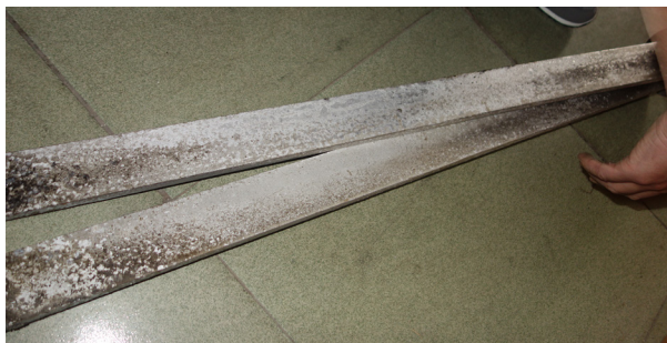
(b) 穿墙套管内部铝排
