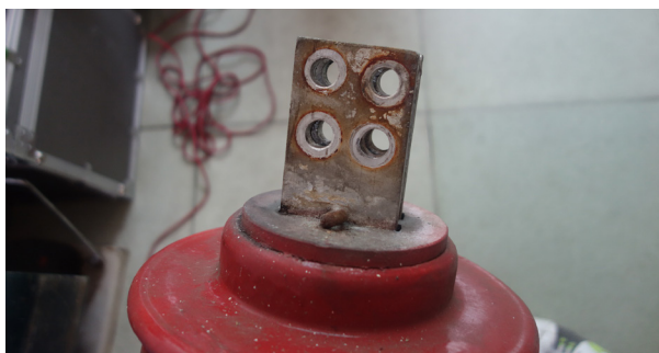
(a) 穿墙套管接线板
