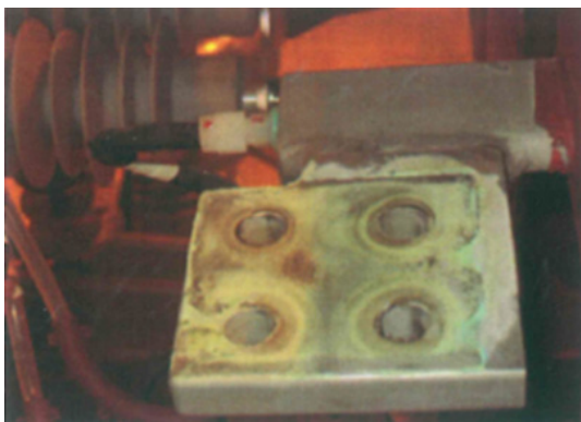
图4 电抗器连接铜排表面干结示意图
