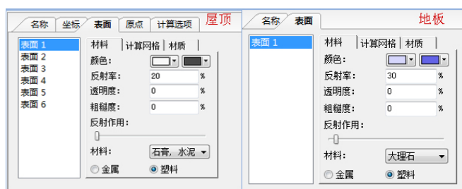
图6 雨棚屋顶、地板参数设置
