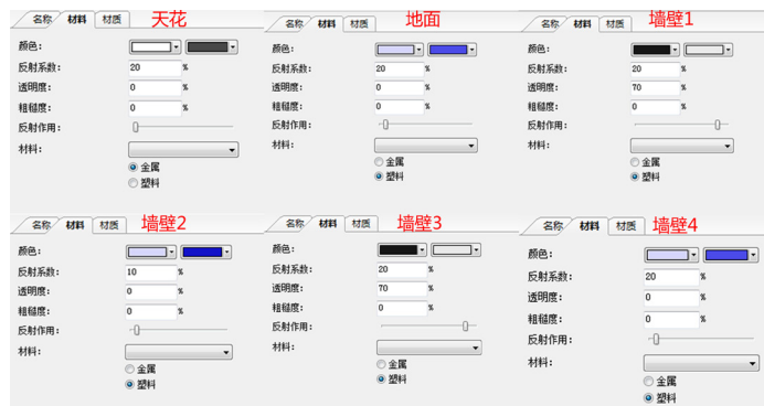
图4 候车大厅天花板、地板、墙壁参数设置
