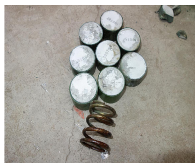
(a) 氧化锌、弹簧受潮锈蚀照片
