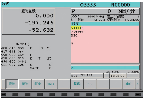
图4 在数控机床端使用DNC远程下载程序的界面
