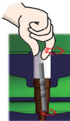
图7 铜套底面磕碰
