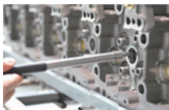
图8 深度规检测压装深度
