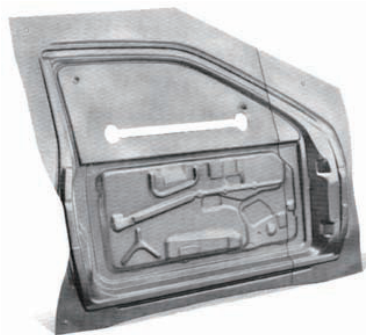
图2 不等板厚拼焊成的前门内板
