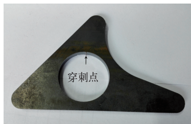
图4 激光切割后零件的实物
