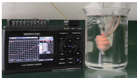
图5 感应加热及温度记录装置
