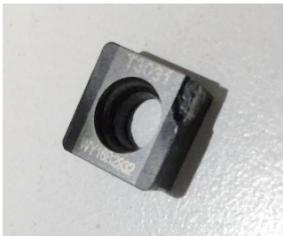
图6 湿式加工刀片崩刃情况
