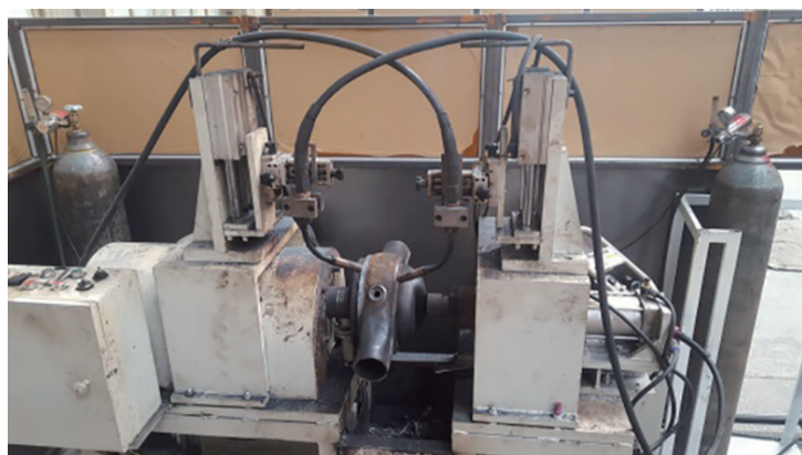
图1 加强环后盖焊接设备
