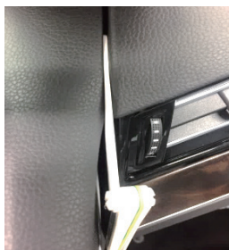
图5 某车型仪表蒙皮与门护板两侧间隙不对称问题
