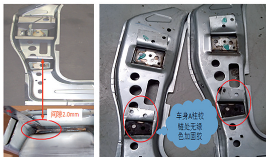
图8 A柱内板破检实验
