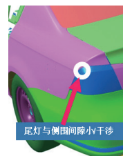
图3 某车型尾灯与侧围间隙问题
